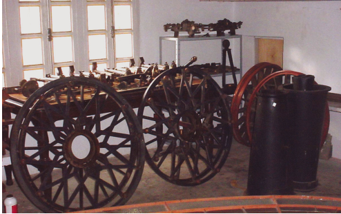
Fig. 25 - Différentes pièces du cercle méridien Gautier démonté, avant restauration. Archives du Museu de Astronomia e Ciências Afins, Rio de Janeiro, Brésil © MAST.
