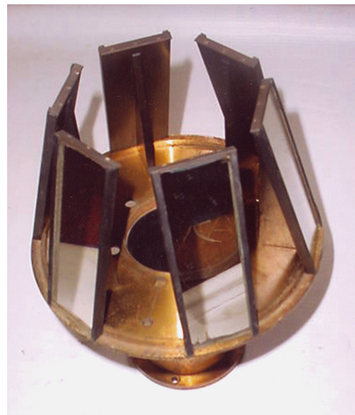
Fig. 20 - Dispositif avec miroirs de renvoi pour l'éclairage du cercle de lecture, après restauration. Archives du Museu de Astronomia e Ciências Afins, Rio de Janeiro, Brésil © MAST.
