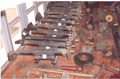
Fig. 21 - Microscopes de lecture des cercles gradués munis de leur micromètre, avant restauration. Archives du Museu de Astronomia e Ciências Afins, Rio de Janeiro, Brésil © MAST.
