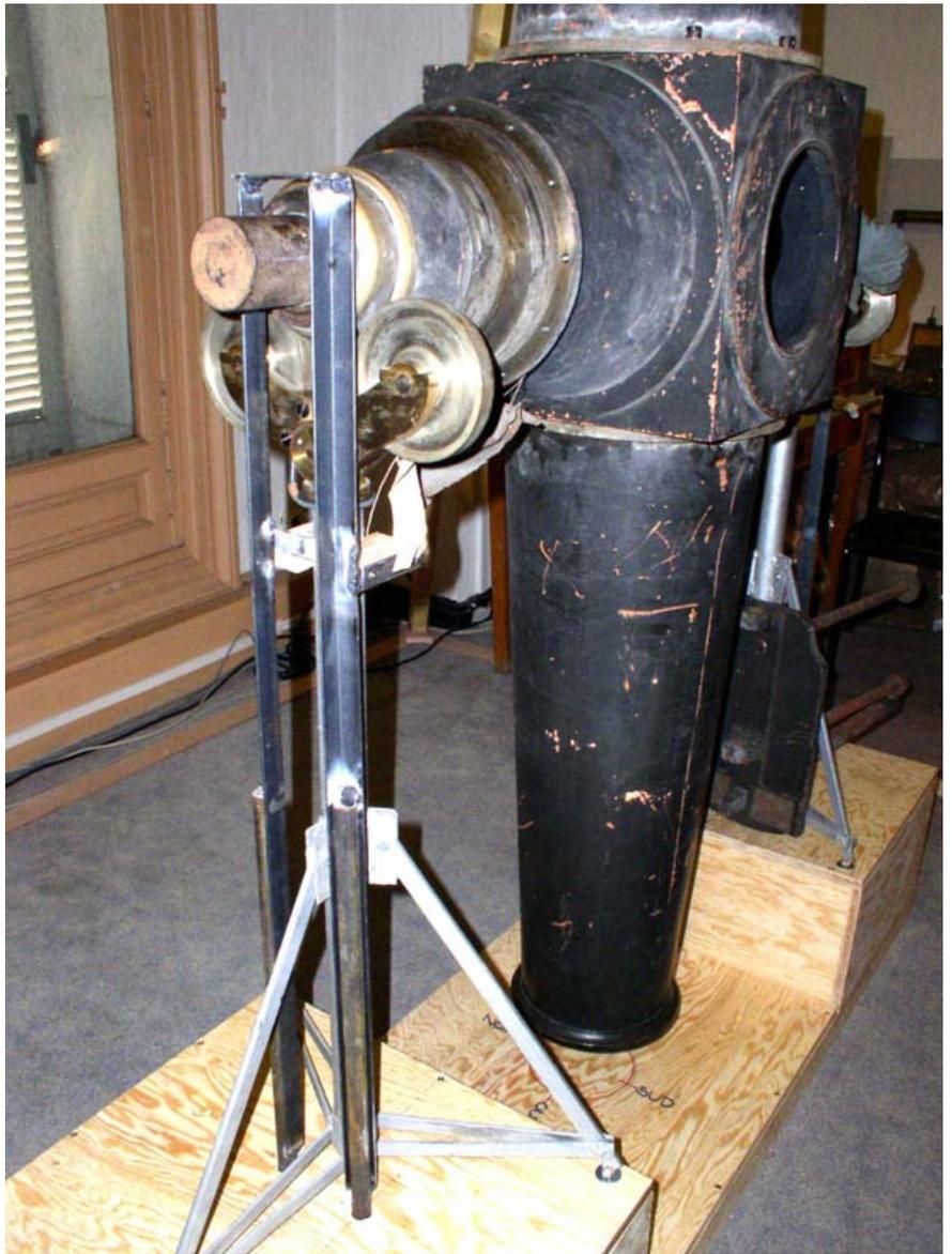
On voit (en bas, au centre) le dispositif qui recevra la tige de la galette, qui appuiera sur un levier. Ce levier (qui repose sur le bois dans la photo) traverse le pilier où un poids d'environ 25 kg est suspendu pour soulager le poids sur les coussinets (qui ne sont pas encore montés).
