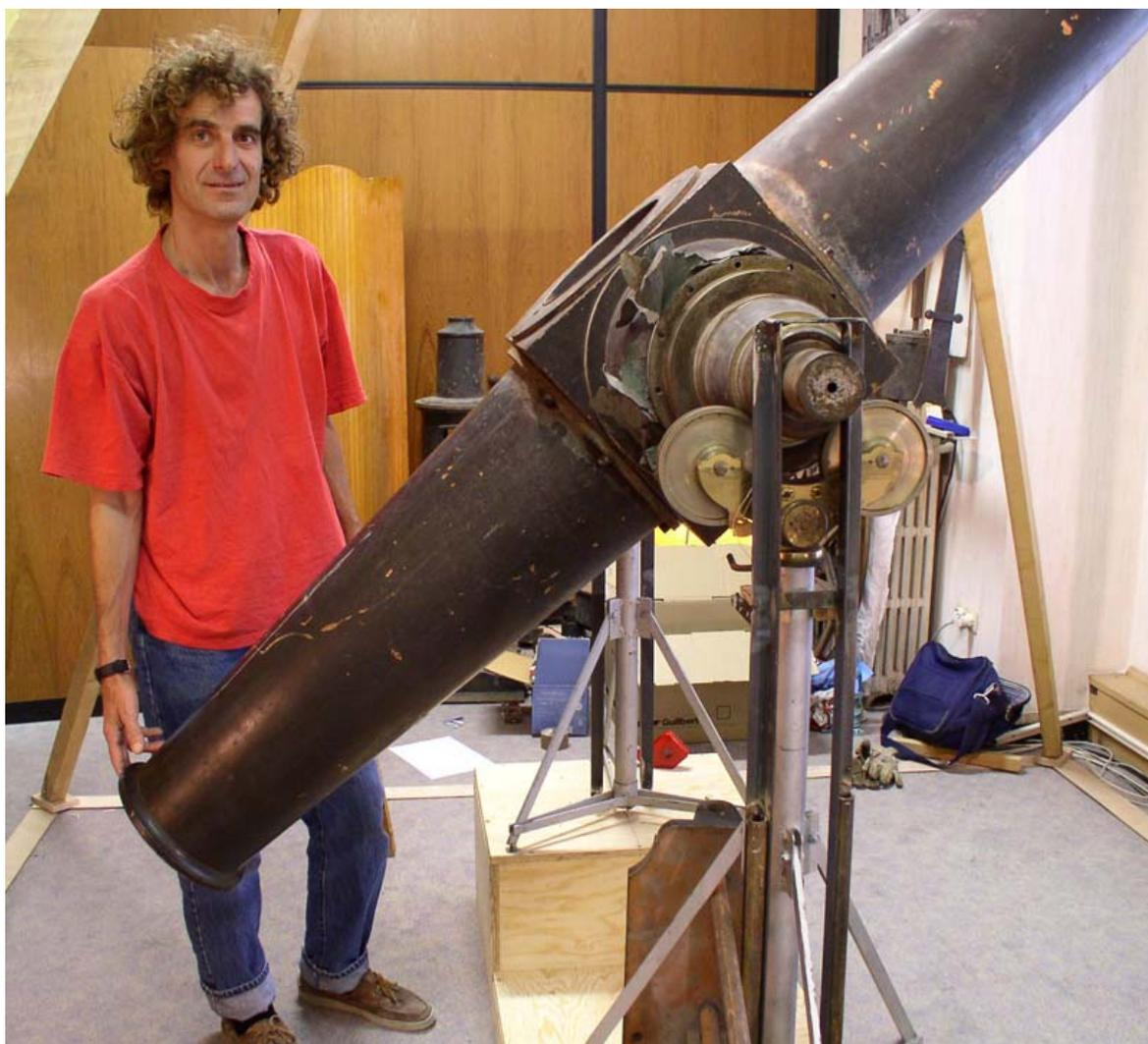
À gauche, l'appareil de retournement (est-ouest) de la lunette; il manque les roulettes. Au milieu, le bain de mercure. À droite, les cercles de calage.
