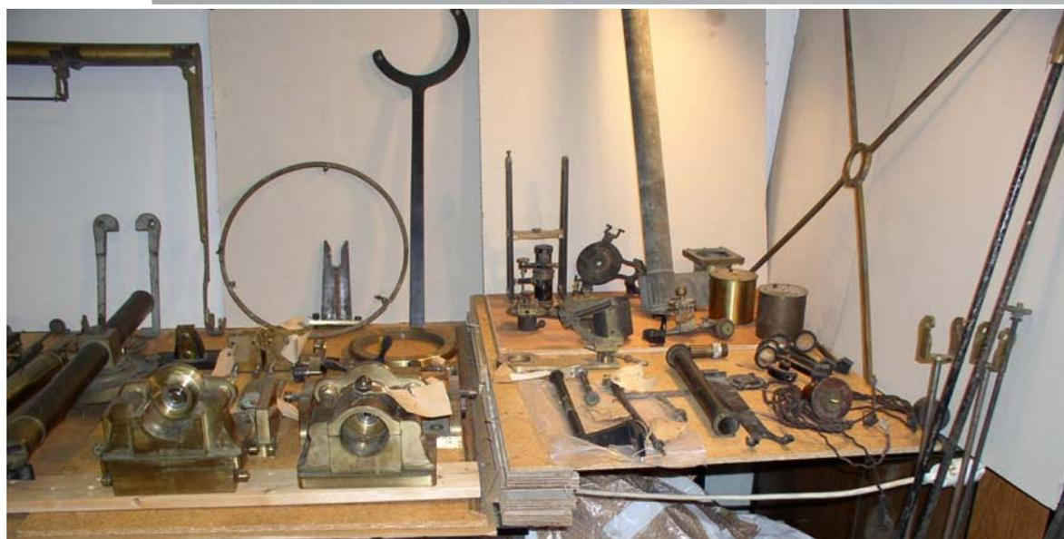
Les deux grosses pièces en laiton, devant, sont les coussinets, qui ne soutiennent qu'une partie infime du poids total, le reste du poids étant soutenu par les galettes actuellement montées.
